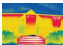
Edificación: pérdida de calor
