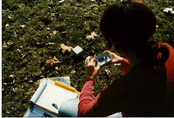
Figura 5: Mesura del soroll elèctric i electrònic ambiental (en nano Volts)
