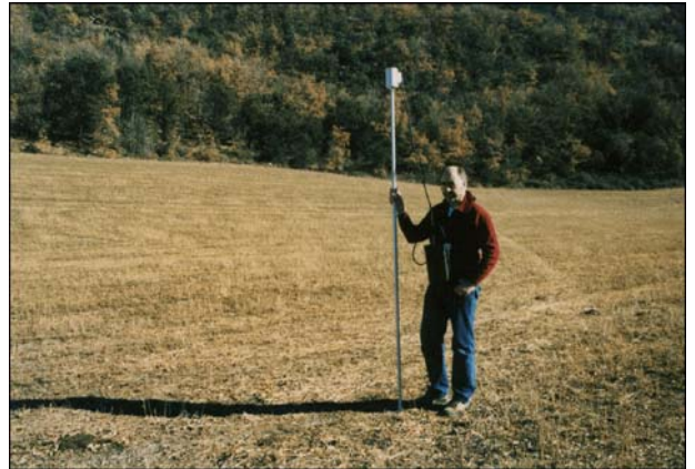
Figura 4: Mesura del camp magnètic terrestre (Magnetòmetre GEOMETRICS) i la distribució del camp magnètic terrestre en tot el planeta
